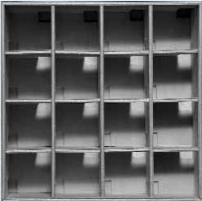
Modell der Lichthöfe mit verschiedenem Lichteinfall
